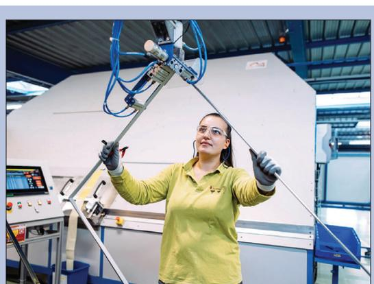
L'atelier compte huit plieuses permettant de réaliser les espaceurs, qu'ils soient en aluminium, comme ici, ou en warm edge. Une soudeuse est utilisée pour fabriquer l'intercalaire Swisspacer, un produit Saint-Gobain haute performance au pouvoir isolant optimisé (matériau composite chargé en fibre de verre).
