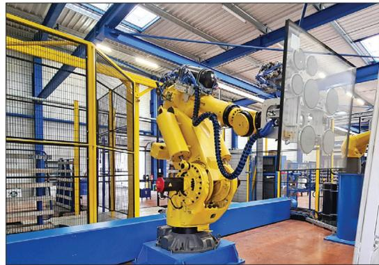
Le deuxième robot prend le vitrage sur le convoyeur et le dépose sur le chariot.
