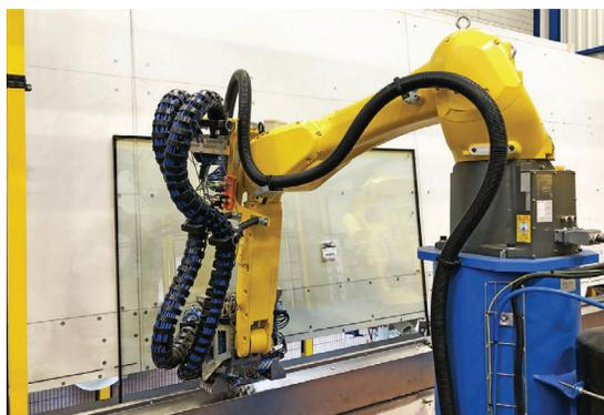
Dépose automatisée de pastilles de liège sur le vitrage.
