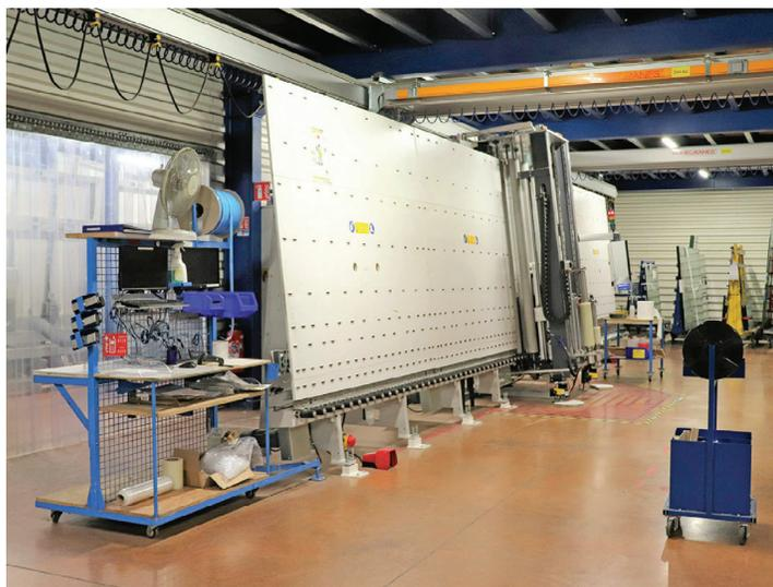
Sur demande, le vitrage reçoit un film de 70 µm grâce à cette machine. Il est ainsi protégé depuis l'assemblage jusqu'à la fin du chantier de construction du bâtiment qu'il va équiper.
