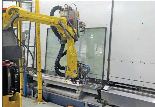
Le premier robot positionne "intelligemment" des pastilles de protection en liège sur le vitrage, selon ses dimensions et sa position sur les agrès.
