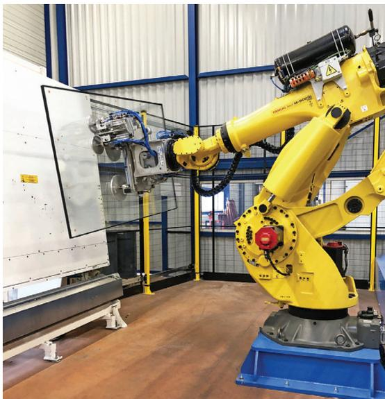
Robot de palettisation : grâce au software Tecauma, il contrôle automatiquement le type d'agres et les caractéristiques du vitrage transmis par l'ERP.
