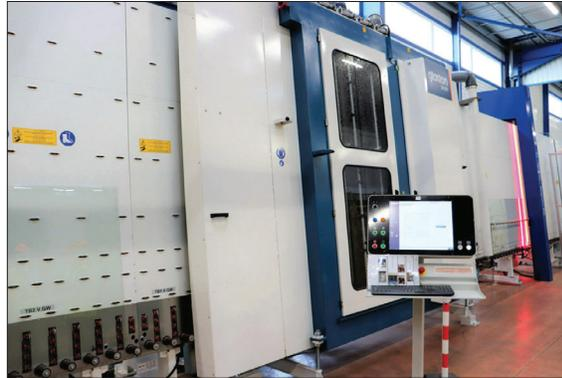
Il est convoyé jusqu'à la laveuse, puis séché et contrôlé au scanner.
