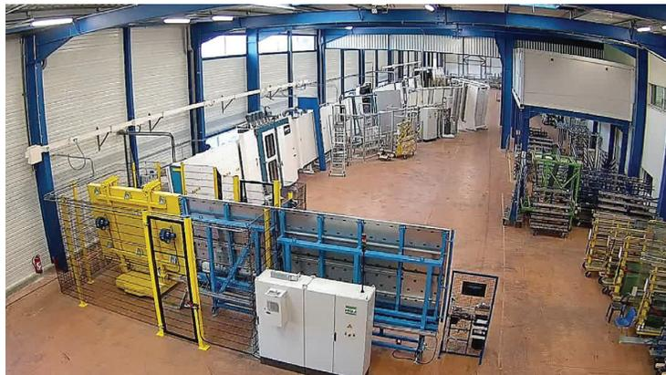
Des 24 000 m<sup>2</sup> d'ateliers sortent 8 000 vitrages par jour, ce qui représente 1,7 million de vitrages isolants fabriqués dans l'année. Ici, la dernière ligne d'assemblage, créée dans une nouvelle extension de plus de 3 600 m<sup>2</sup>.
