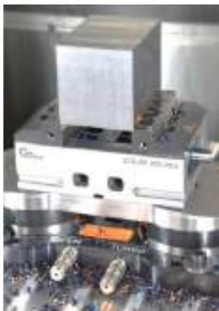
Une prise minimale sur un talon de 3.5mm seulement pour optimiser la taille de vos bruts. Un serrage puissant allant jusqu'à 65KN qui permet une tenue parfaite des pièces même soumises à des efforts d'arrachement intenses. **Nul besoin de faire des empreintes préalables sous presse manuelle ou d'usiner des bruts** en queue d'aronde. Les plaquettes carbure sont adaptées à chaque matière et sont facilement logeables dans des mors standards ■
