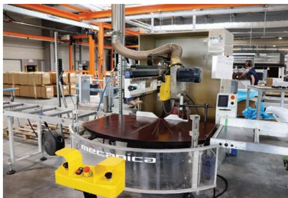
Cette scie mono-tête Mecnica arrivée en janvier est utilisée pour les lames de grandes dimensions (jusqu'à 600 mm de large, quand les plus étroites mesurent 50 mm).
