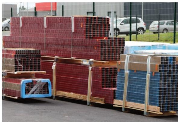
95% des chantiers utilisent des lames de 7 m au plus ; la longueur maximale ne peut excéder 7,5 m-8 m, pour des raisons de manutention et de capacité de laquage.
