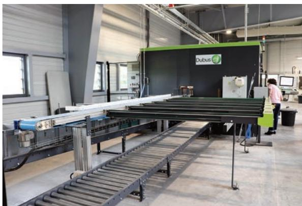
Ce banc BDM installé en janvier, fabrique tous les types d'accessoires de fixation. 12 barres sont chargées à la fois, pour un usinage en autonomie pendant une demi-journée. Cette machine a permis de gagner 30 % de capacité sur le temps d'usinage d'une barre.
