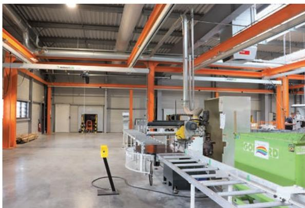
Le système d'aspiration centralisée des fumées et copeaux volatiles améliore l'environnement de l'opérateur et réduit le nettoyage de fin de semaine.
