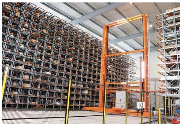
Le bâtiment a été créé autour du transstockeur Tecauma de 750 emplacements, qui occupe à lui seul plus de 1 300 m<sup>2</sup>. Cette solution de gestion des stocks et de logistique permet de garantir un délai optimal dans la fabrication des produits. Ces derniers mois, le stock de lames brutes a augmenté pour garantir des délais de livraison de 8 à 15 semaines en moyenne.
