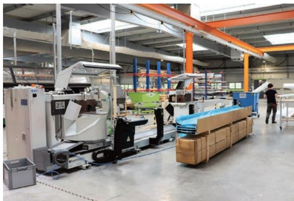
Installée en mars, cette scie double-tête FOM, l'une des plus grosses du marché, permet de débiter des profils jusqu'à 500 mm de large avec différents angles en rotation et en inclinaison.
