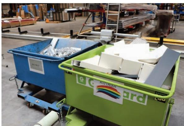
Les chutes d'alu laqué et brut sont séparées en vue d'un recyclage. Les barres de 2 m sont conservées et réutilisées.
