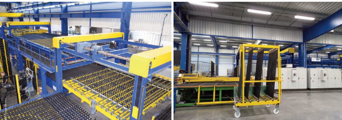
Chez TIV, une installation Hegla unique au monde accueille, coupe, alimente sur deux niveaux deux lignes d'assemblage de vitrages isolants via un tri dynamique en un flux continu 4.0 capable d'assumer jusqu'à 3 coupes en simultané de panneaux de 2,50 x 4,50 m ; elle regroupe le magasin de stockage du verre "Remaster", le pont de coupe "RapidLam", le retourneur l'ascenseur et le convoyeur ; à l'arrivée, productivité, sécurité et qualité exceptionnelles alignées dans la philosophie du groupe, "Tout en ligne et ne plus toucher le verre". Sur un étage, la Streamlam réduit de 50 % l'occupation au sol et permet ici d'économiser 1 000 m 2 supplémentaires de surface
